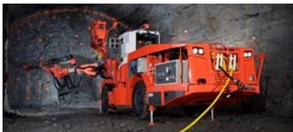
トンネル穿孔機械(Jumbo)
